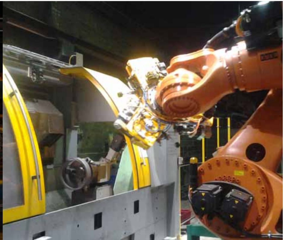
Ökad automatisering skapar säkrare arbetsmiljö. Bilderna visar tidigare manuella hantering och nuvarande robot för samma lastning och lossningsmoment i ringverk 8.
