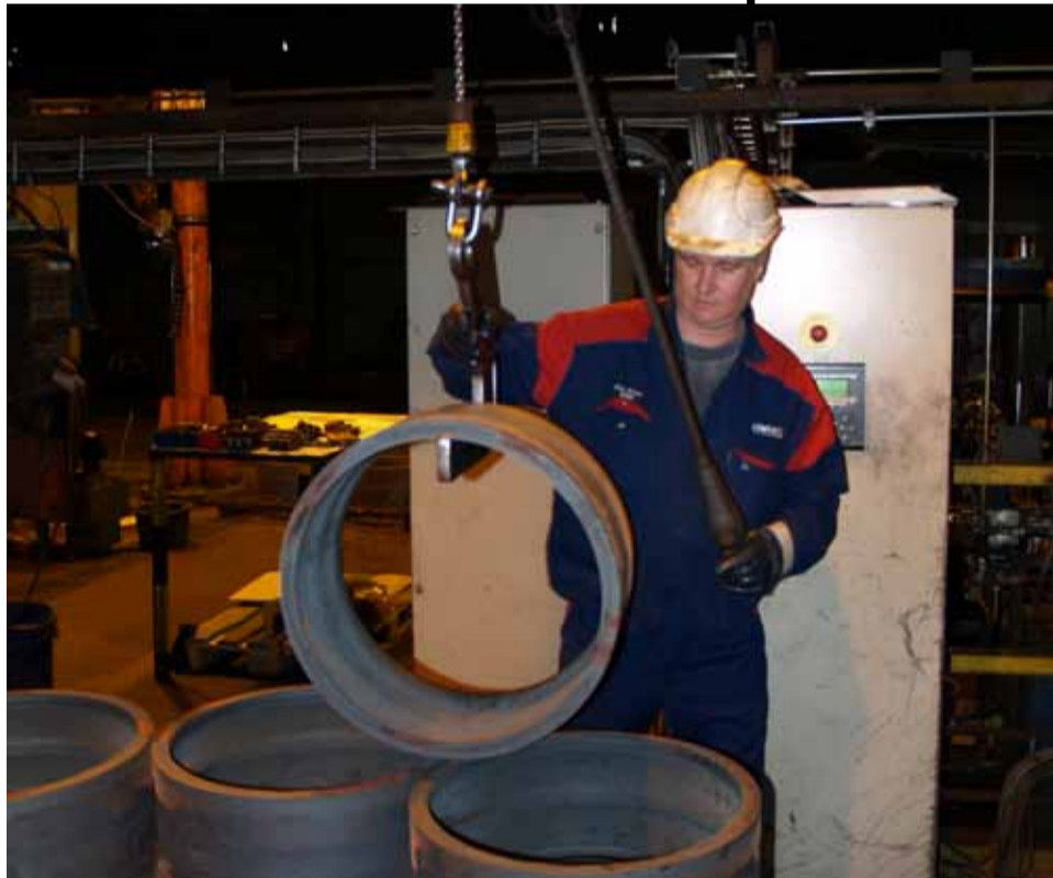
Ökad automatisering skapar säkrare arbetsmiljö. Bilderna visar tidigare manuella hantering och nuvarande robot för samma lastning och lossningsmoment i ringverk 8.
